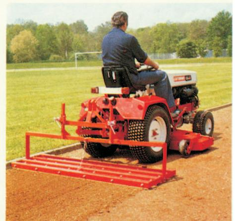
Zum Heckenbau stehen verschiedene Pflegegeräte wie Bürste, Rechen, Egalisiergerät und Walze zur Verfügung. Bis zu zwei Geräte können miteinander kombiniert werden. Arbeitsbreite 1,20 m oder 1,80 m.
