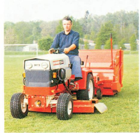
Verfilzung wirksam vorgebeugt wird. Der geschlossene Sammelbehälter faßt 1600 bzw. 2000 l. Arbeitsbreite 1,2 bzw. 1,5 m.
